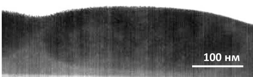
Рисунок 3 - HAADF-СПЭМ изображение эллипсоидного домена в сечении фотоактивного слоя РТВ7:РС71ВМ.
